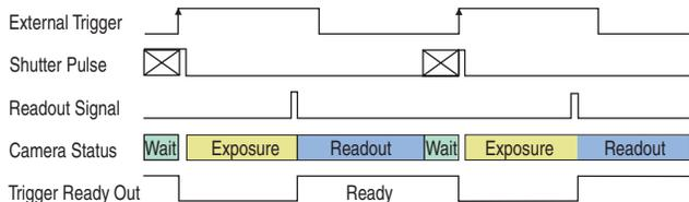
Fig. 11 Edge trigger
